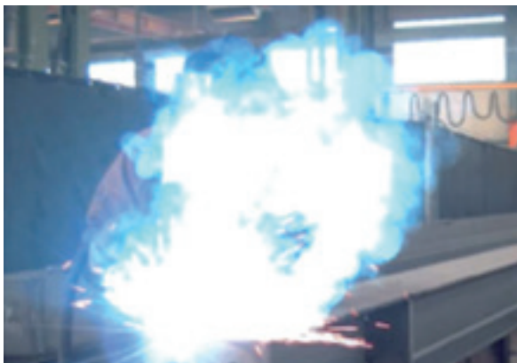
Bisher: Hohe Schweißrauchentwicklung im konventionellen Schweißprozess.
