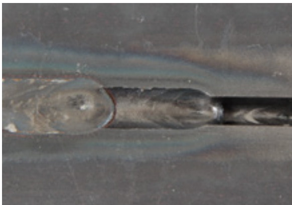
FOCUS.PULS - Mehrlagenschweißung mit reduziertem Öffnungswinkel (25°) Höchste Nahtsicherheit siehe Schliffbild. Das Ergebnis zählt!
