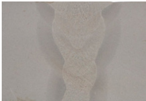
FOCUS.PULS - Mehrlagenschweißung mit reduziertem Öffnungswinkel (25°) Höchste Nahtsicherheit siehe Schliffbild. Das Ergebnis zählt!
